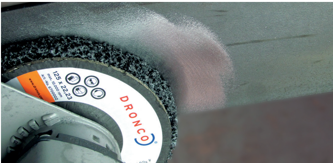
Reinigen/Entzundern einer Stahloberfläche mit dem Grobreinigungsvlies
