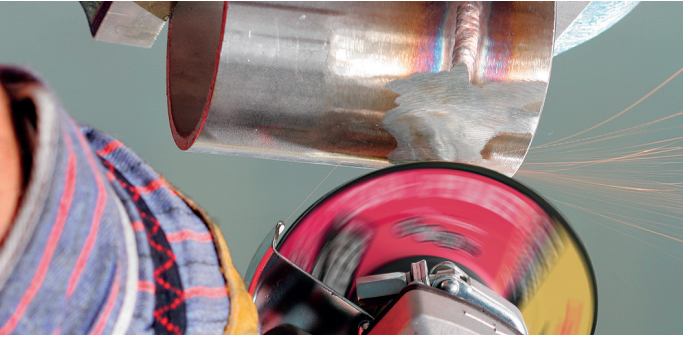
Schneller und hoher Materialabtrag mit einer Schruppscheibe
