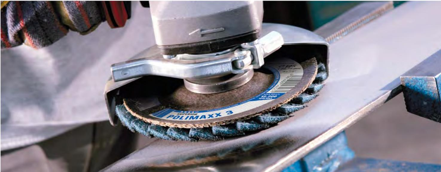
Polierfächerscheiben liefern durch ein innovatives, hochwirksames Schleifvlies in fächerförmiger Lamellenstruktur herausragende Ergebnisse bei der Bearbeitung von Edelstahl, Stahl, Aluminium und NE-Metallen.
